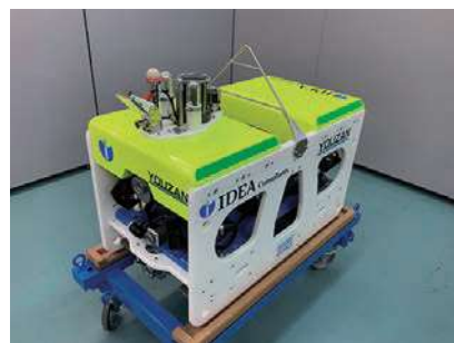
水中調査ロボット(ホバリング型AUV「YOUZAN」)
